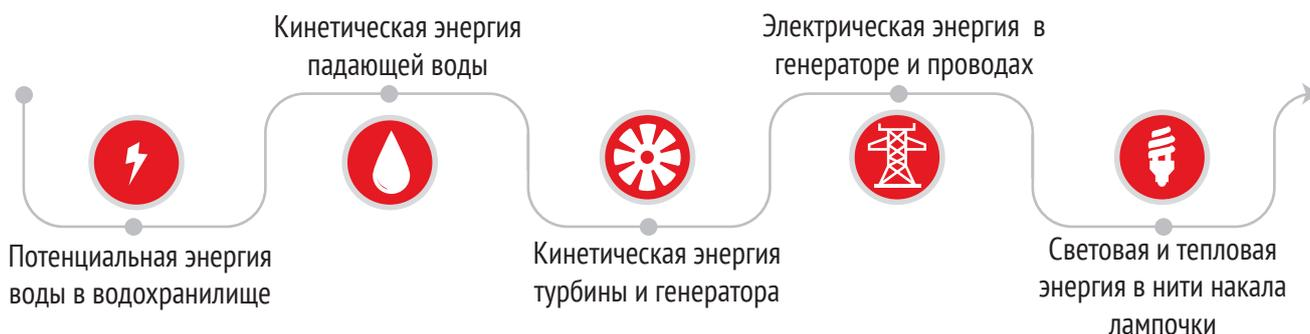
Рисунок 1.17. Процесс преобразования и потребления электрической энергии
