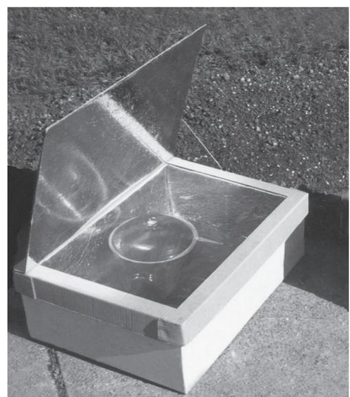
Рисунок 2.16. Солнечная печь коробчатого типа
