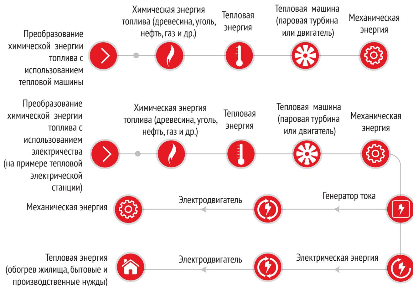
Рисунок 1.15. Преобразование энергии на тепловой электрической станции
